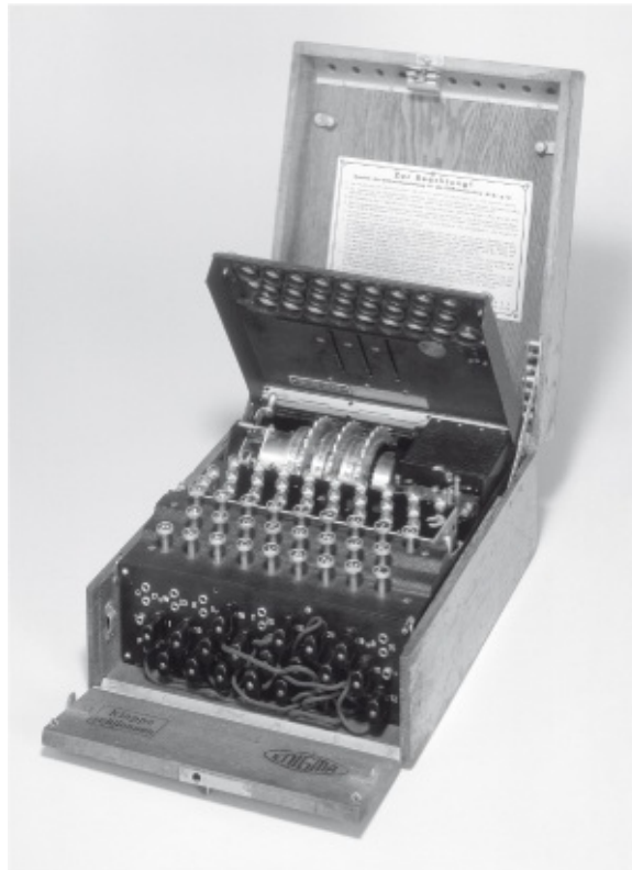
Figura 6. La máquina Enigma, con sus rotores, sus luces y el panel de control a la vista. Crédito: Science Museum / Science & Society Picture Library. —Todos los derechos reservados.
